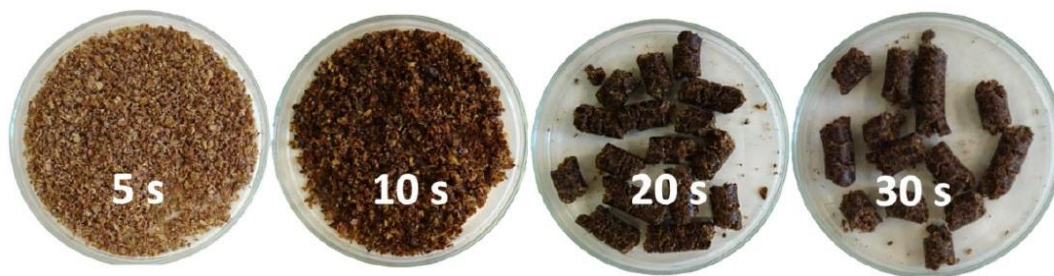
Obr. 13: Struktura výlisků lnu setého (odrůda Libra) ze sklizně 2021 po lisování na ústrojí s 10 mm tryskou (Zdroj: J. Kyselka)
