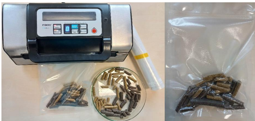
a) Balení výlisků externí vakuovou balíčkou Maxxo (Foto: E. Jarošová)
