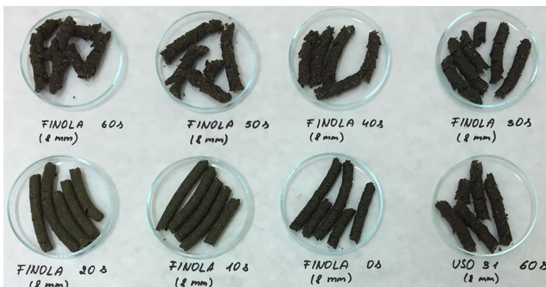
Obr. 14: Struktura výlisků konopí setého (odrůda Finola) ze sklizně 2020 po lisování na ústrojí s 10 mm tryskou (Foto: J. Kyselka)
